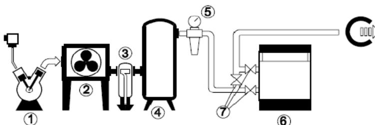
**B)** Le sécheur doit être installé avant le réservoir quand celui-ci est dimensionné pour permettre de larges variations du débit d'air utilisé dont les valeurs de crête sont très supérieures au débit maximum du compresseur.
